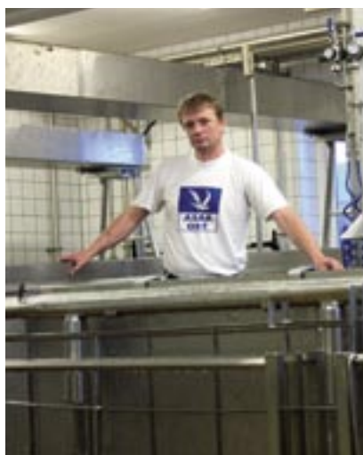
Mejeribestyrer Per Jensen i det nyrenoverede osteri, hvor rustfrie materialer har erstattet jern og træ.
